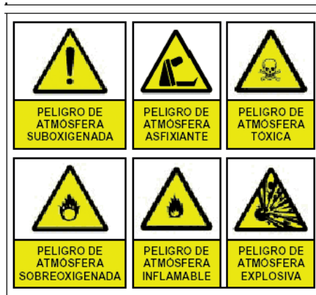
Señalizaciones de Advertencia en Espacios Confinados
